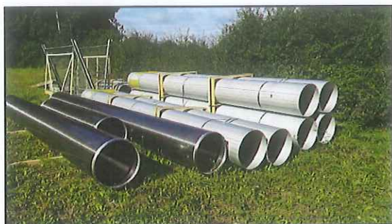
Tubes en inox pleins et crépinés de diamètre 508 mm
